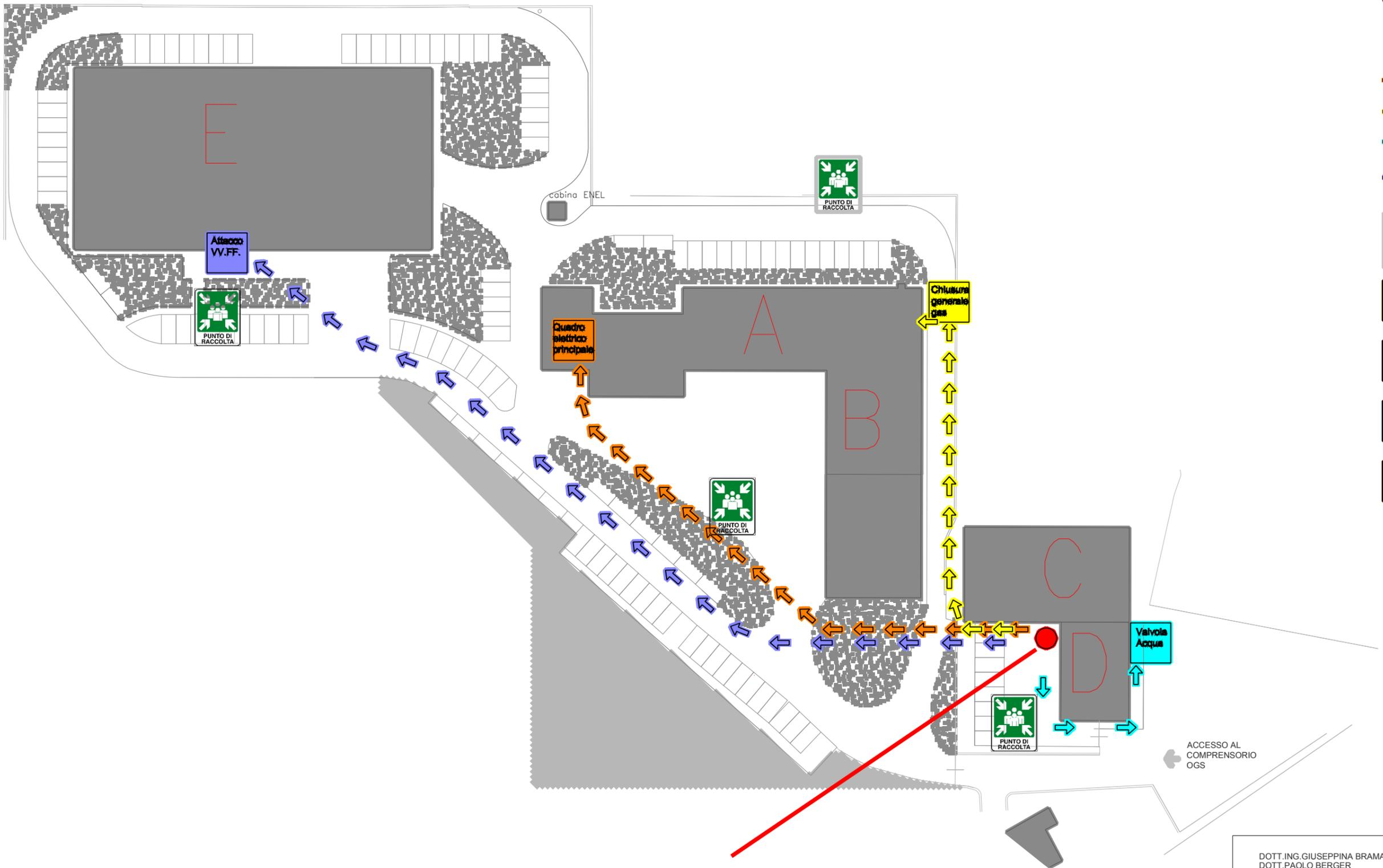
**PER ISOLARE COMPLETAMENTE L'EDIFICIO D ( PALAZZINA MORELLI) OLTRE CHE SUL PULSANTE DI SGANCIO E' NECESSARIO AGIRE SULL'APPOSITO SEZIONATORE SUL QUADRO ELETTRICO PRINCIPALE RAGGIUNGIBILE SEGUENDO IL PERCORSO RAPPRESENTATO IN ARANCIO SULLA PRESENTE PIANTA**
